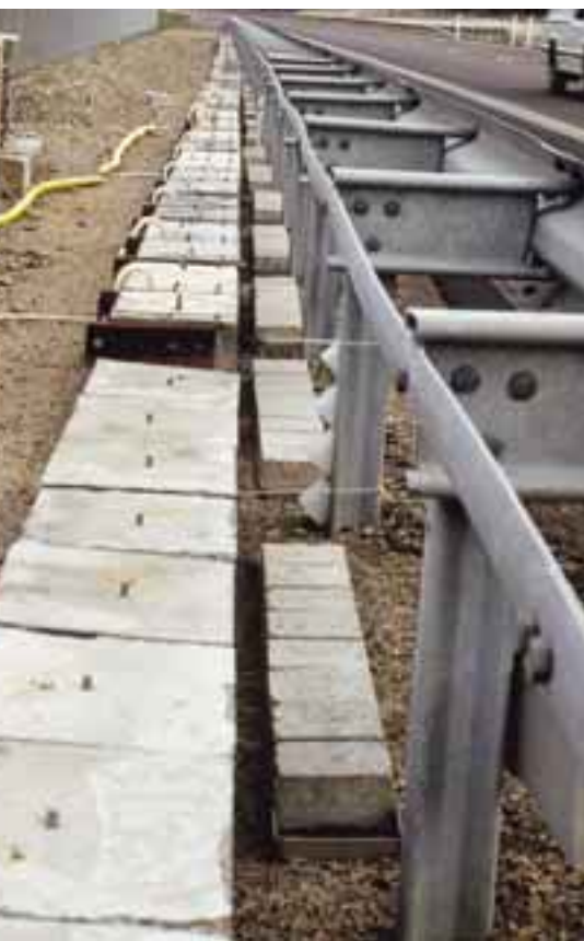
1a, 1b Koekappaleiden sijainti Rv40:n varrella. Pienempi koekappale on pakkasrapautumisen ja isompi kloridien tunkeutumisen ja raudoituksen korroosion seuranta varten /3/.
