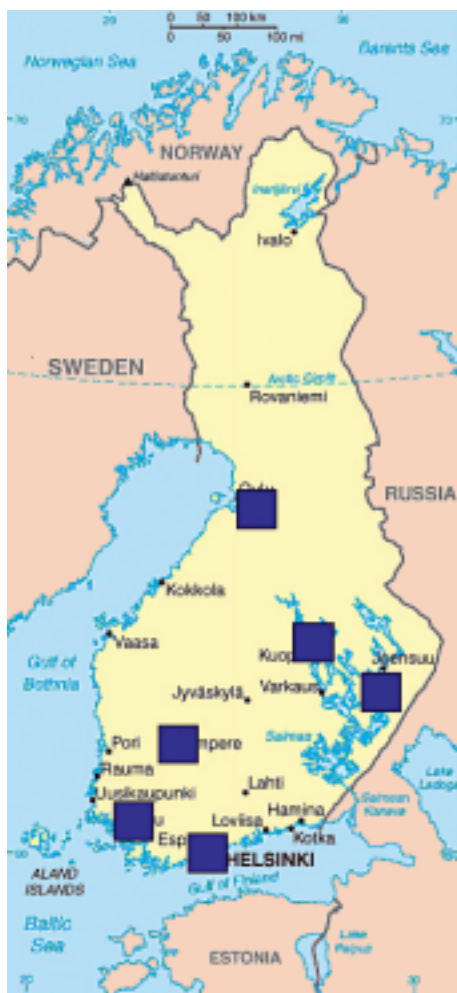
1 Alueet, joilla Suomessa on todettu rakenteissa alkali-kiviainesreaktioita.
