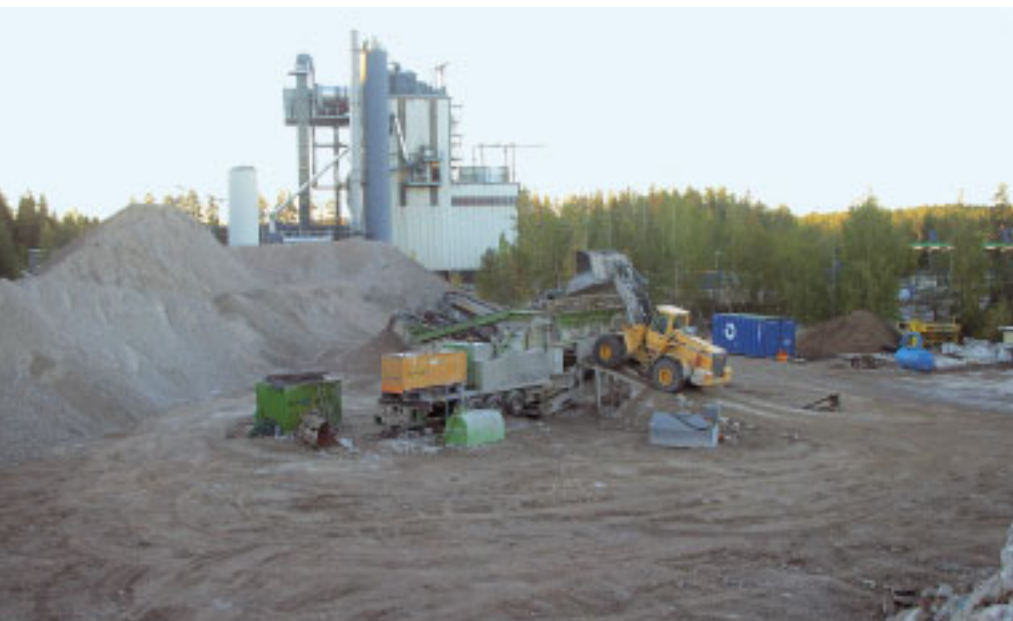
2 Betonijä- ja tiilijätteen esikäsittelyä Helsingin Konalassa.
