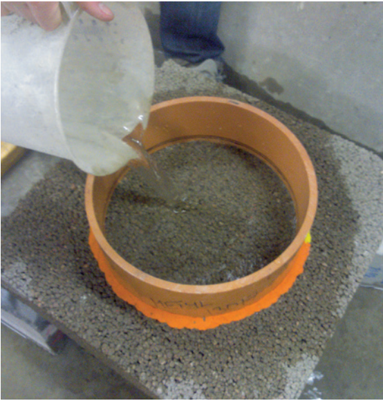
7 Betonikivipinnan vedenläpäisevyys määritellään Rig-testauksessa ja single-ring-menetelmällä (ASTM).
