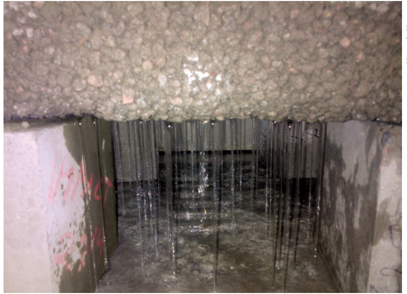
8 Vettä läpäisevän betonin (LB) rakenne. Vettä läpäisevien toisiinsa yhteydessä olevien huokosten koko on pääosin 1–8 mm. Sementtipastan suojuhuokokset (<0,8 mm) takaavat LB:n hyvän pakkasenkestävyyden.
