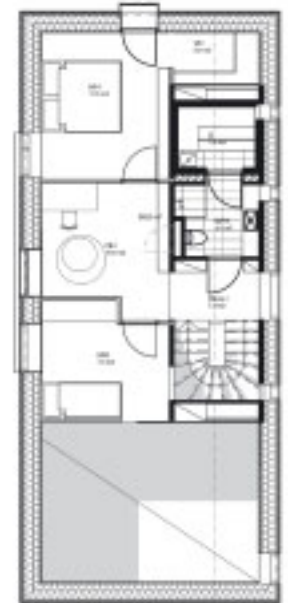
8 Sydän+puu small-malli, johon on sijoitettu betoninen Sydän-tilaelementti. Koko talotekniikka on keskitetty esivalmistettuun betoniseen tilaelementtiin.
