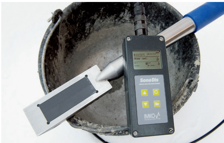
5 SONO-WZ laitteisto tuoreen betonin vesimäärän mittaamiseen.
