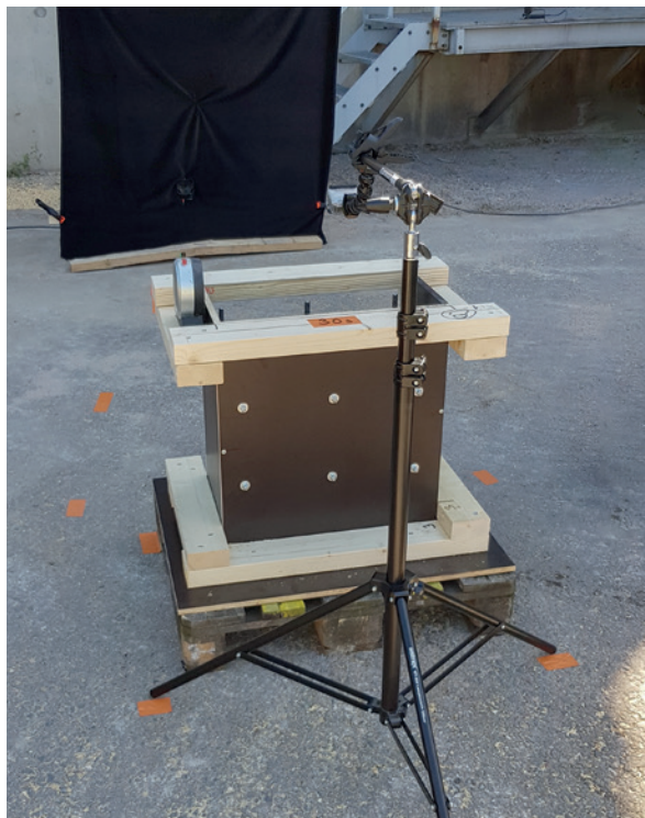
Kuva 1 Tiivistystä videoitiin kahdesta eri suunnasta muotin etupuolelta ja muotin päältä.
