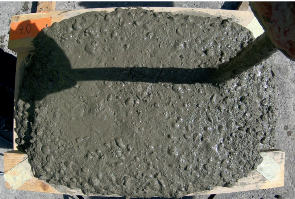
Kuva 5 Tiivistys on lähellä optimia. Pinnan kupliminen on vähentynyt, kiviainesrakeita on vielä lähellä pintaa ja sementtipastaa ei ole erottunut betonipinnalle.
