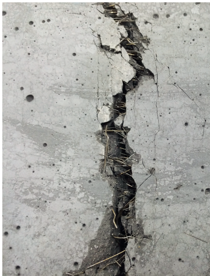
11 Lähikuva taivutuskokeen läpikäyneestä ultrakorkealujuusbetonin koe-kappaleesta. Geneerinen lähikuva betonista. Kuva on Kotkavuon Japanin opiskelijavaihdolta.
