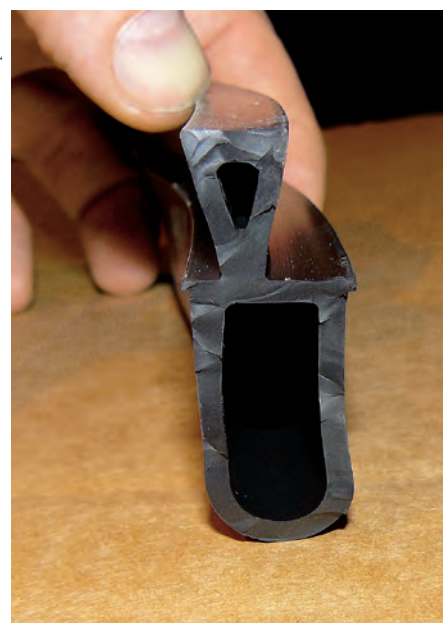
9 Kumitiiviste sijoitettiin tehtaalla sandwich-elementin muottiin kahdelle sivulle. Tällöin julkisivujen saumat olivat heti asennuksen jälkeen sateelta suojattuja ennen lopullista saumausta.
