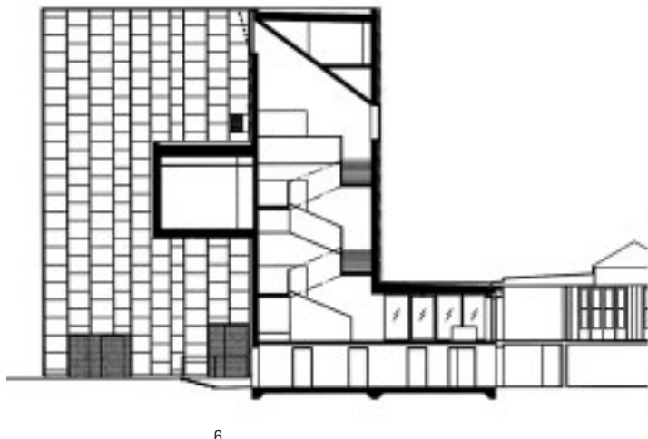
6 Leikkaus portaan kohdalta. Laatikko portaan vieressä on videohuone.
