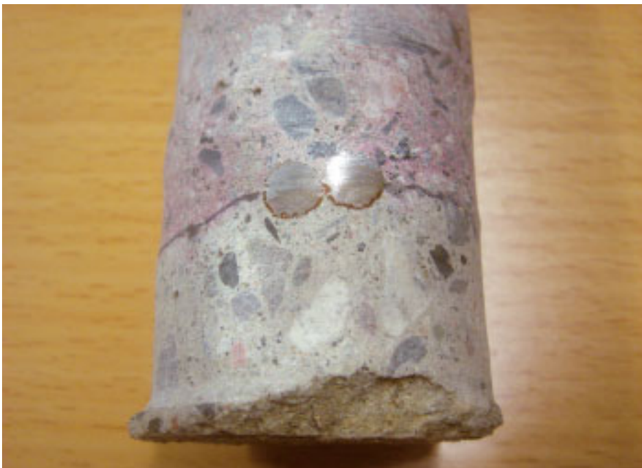
3 Tyypillisimmin korroosioaurioita esiintyy elementtien sellaisten pieliterästen kohdilla, joissa peitepaksuudet ovat pieniä ja saderasitus suurta.
