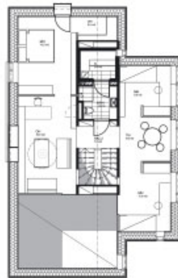
7 Sydän+puu large -mallin kaksikerroksisissa versioissa on tilaelementtiin sijoitettu myös portaat.
