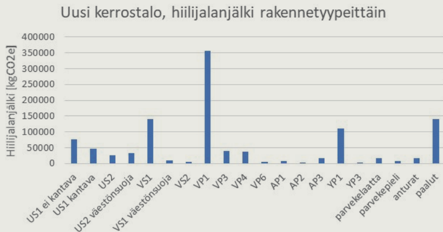
Kuva 2 Betonielementtirakenteisen asuin- kerrostalon rakennetyyppien kokonaishiili- jalanjälki [kgCO 2 e, A1-A5, C1-C4]
