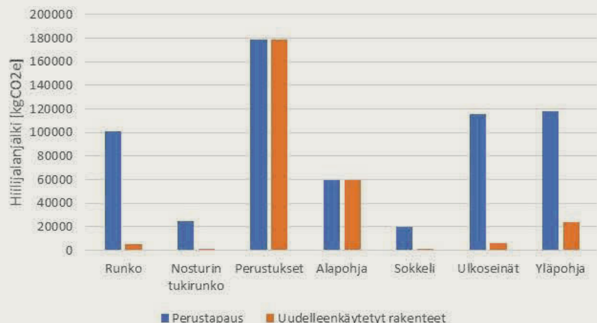
3 1000 m 2 teollisuushallin eri rakennusosien hiilijalanjälki verrattuna uudelleenkäytettyistä elementeistä rakennettuun halliin [4].
