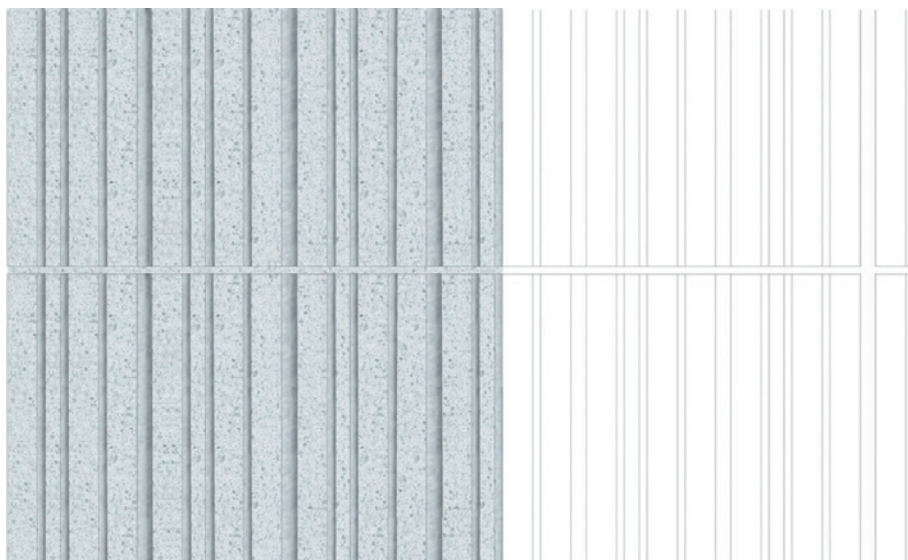
Betonielementtien toistuva urituskuvio 1:1
