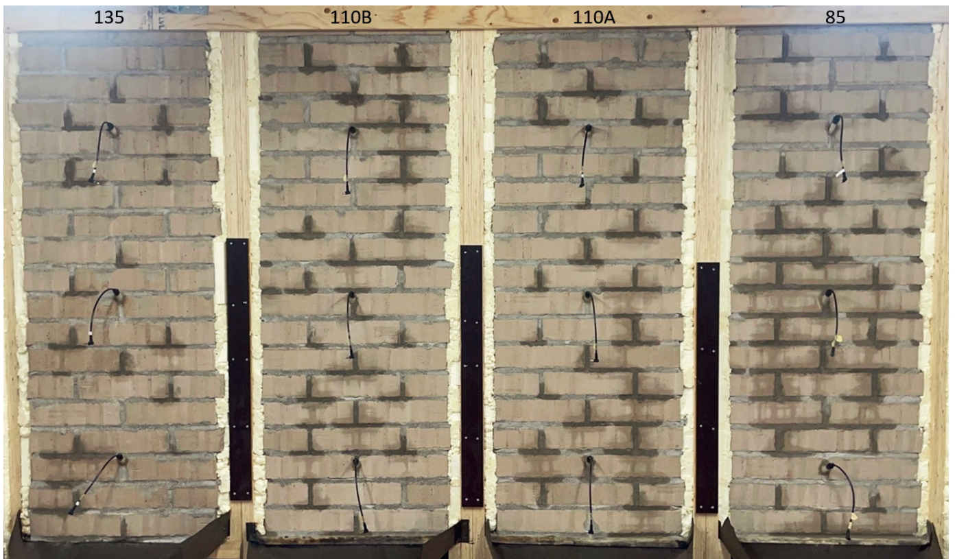
4 Koeseinien taustapinnat testin 5 (suurin sadetusmäärä) kaikkien sadetussyklien jälkeen, 9 tuntia testin aloituksesta.
