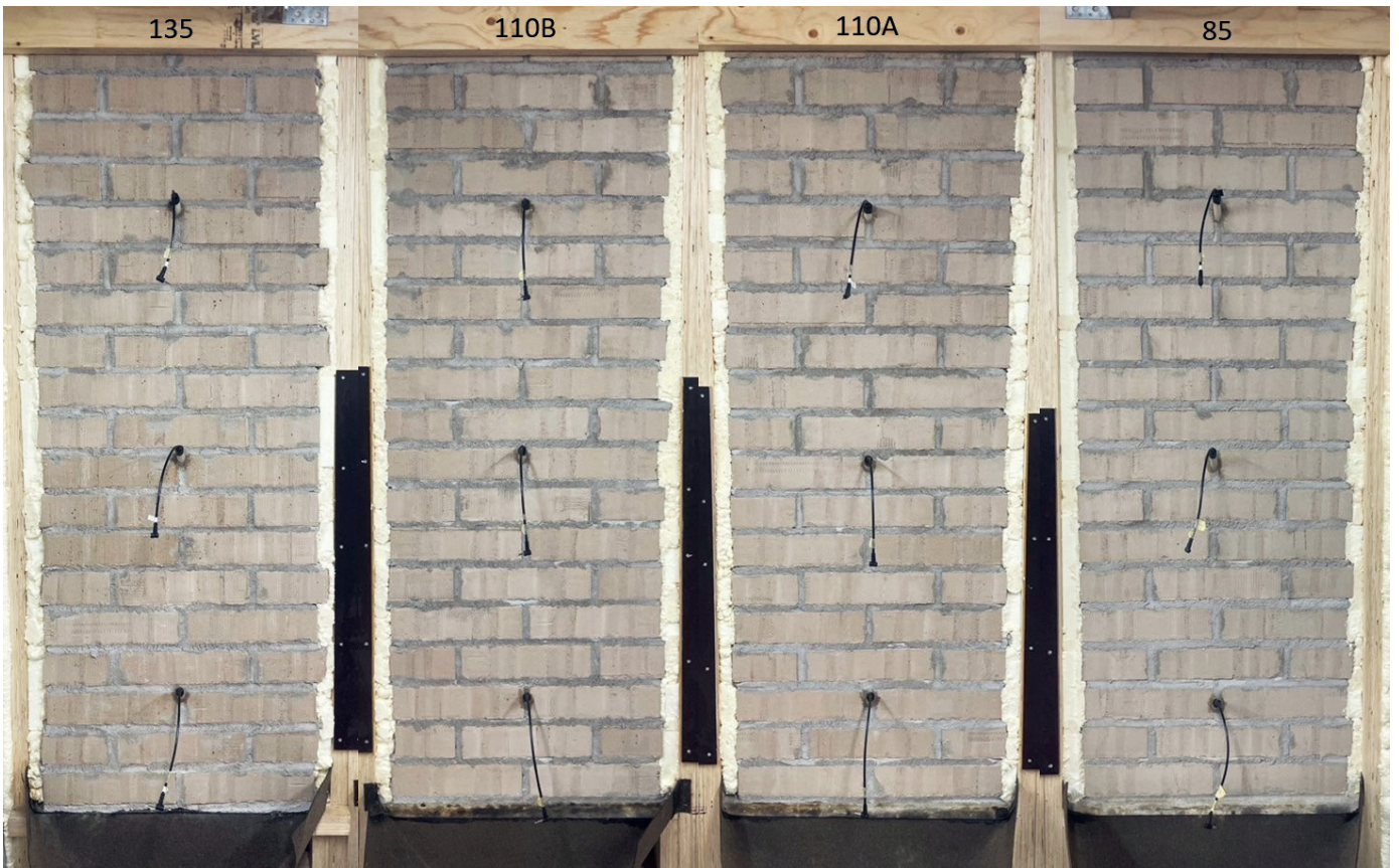
3 Koeseinien taustapinnat kuivina, ennen sadetustestin aloitusta.
