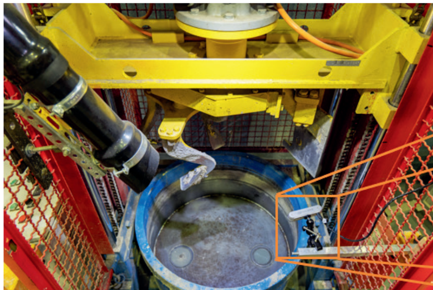
8 Syvyyskamera sijoitettiin taltioimaan betonipinnan muodonmuutoksia..
