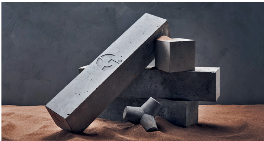
2 Betolarin Geoprimeella on tehty mm. sementtivapaita betonituotteita, joiden CO 2 -päästö on 80 % perinteistä betonia vähähiilisempi.
