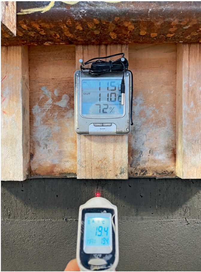
6 Ville Hakala mittaa muotista ulos tulevan betonin lämpötilaa.
