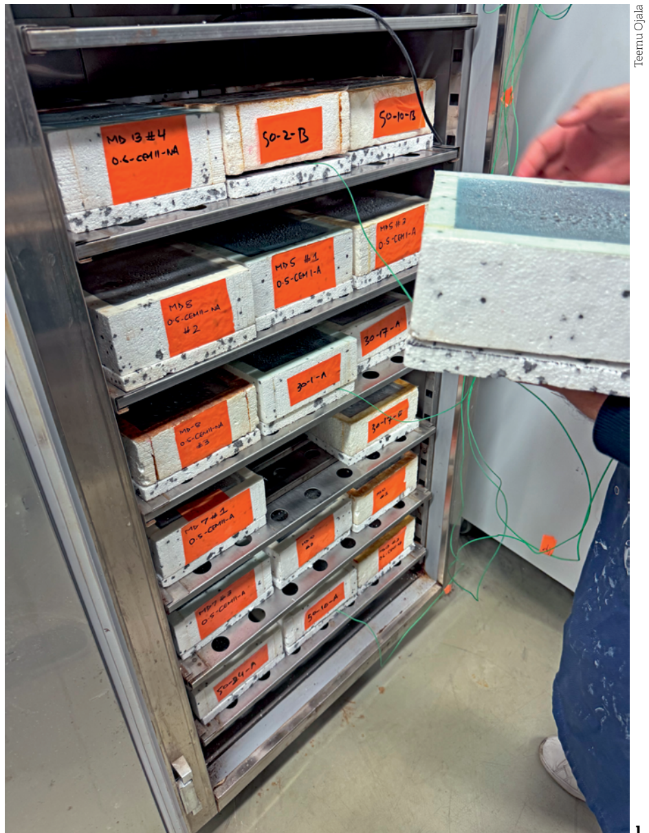
Kuva 2 Laattanäytteen testipinnalle annosteltu jäädytettävä aine aiheuttaa toistuvan jäädytys-sulatusrasituksen teknisen spesifikaation CEN/TS 12390-9 [2] mukaisesti.
