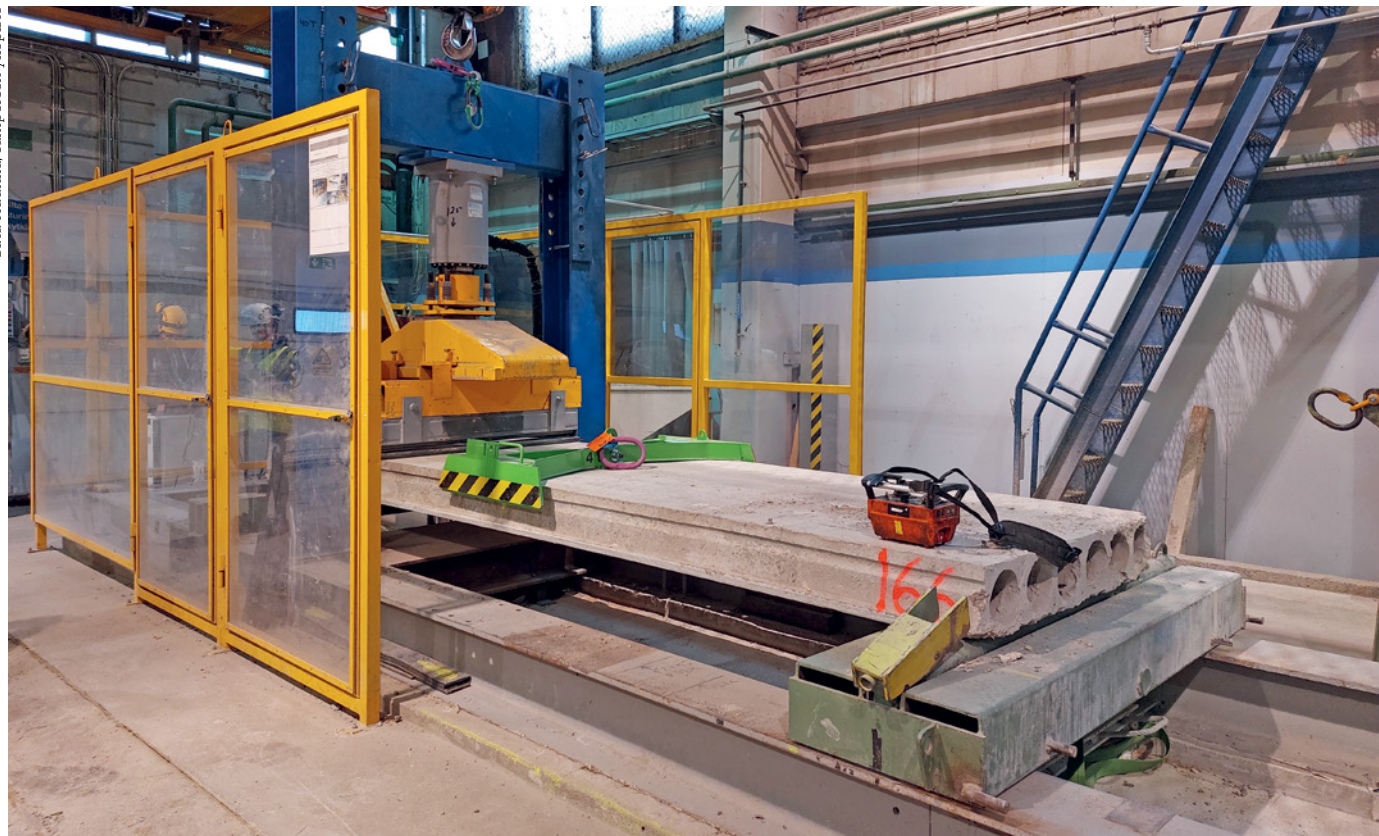
17 Ontelolaattojen testausta Consolis Parman tehtaalla.
