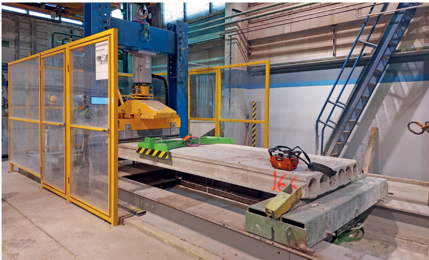
17 Ontelolaattojen testausta Consolis Parman tehtaalla.
