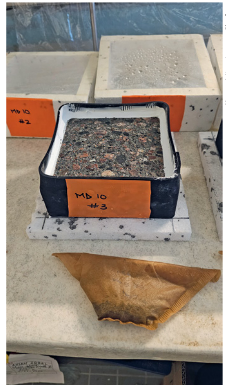
Kuva 2a ja 2b Näytteiden koestaminen jäädytys-sulatuskapaissa (vasemmalla) ja rapautuneen materiaalin keräys (oikealla).
