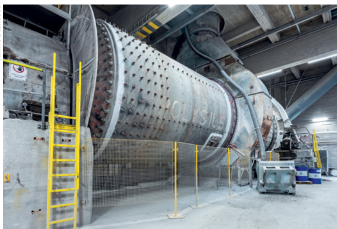
3 R7-raakajauhemylly Finnsementin Paraisten tehtaalla.
