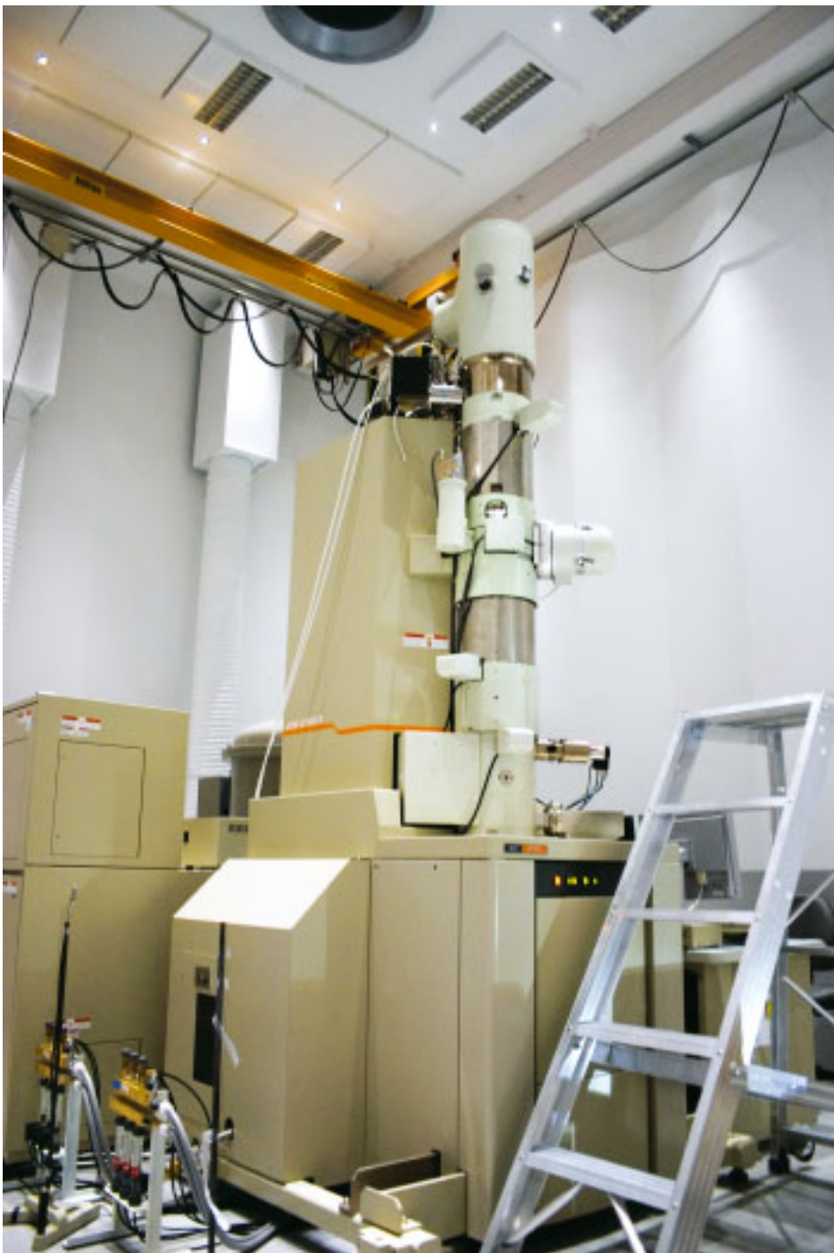
14 Aalto-yliopiston TEM (JEOL Atomic resolution microscopes, 2-Cs correctors). Laitteen korkeus on noin 5 m.
