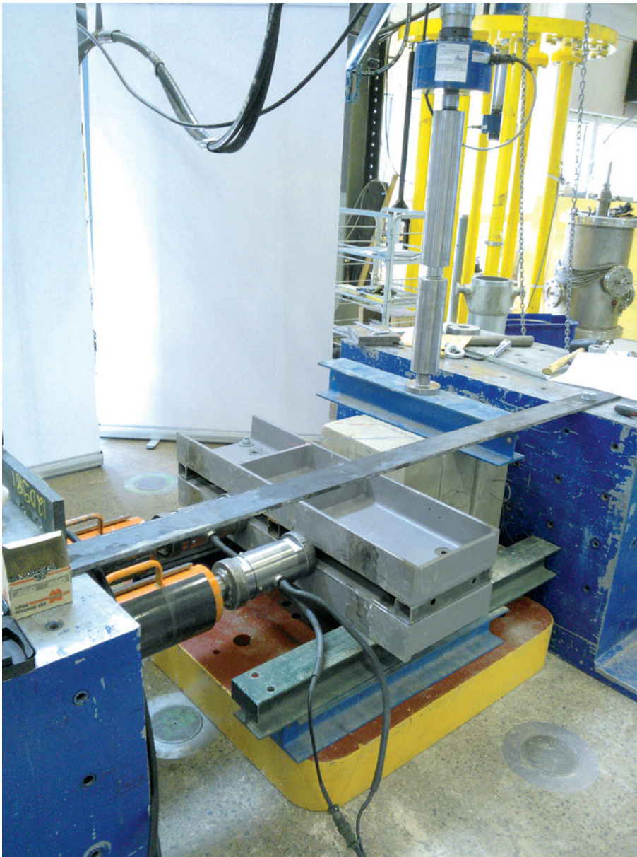
3 Kitkakertoimen mittausjärjestely. Koekappaleet ovat betonikappaleiden välissä.
