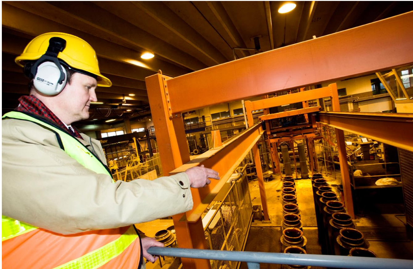
Betoniputken sisään tuleva raudoteikin valmistuu automaattisesti.
