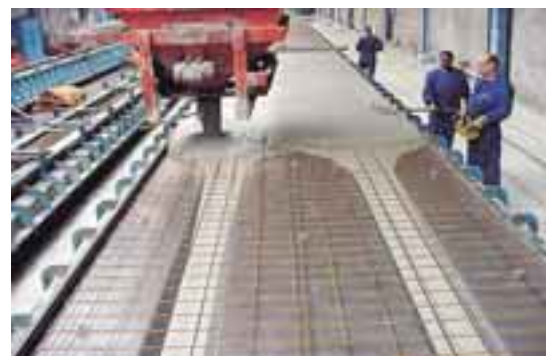
4 Hollannissa itsetiivistyvää betonia käytetään paljon elementtitehtaisissa.
