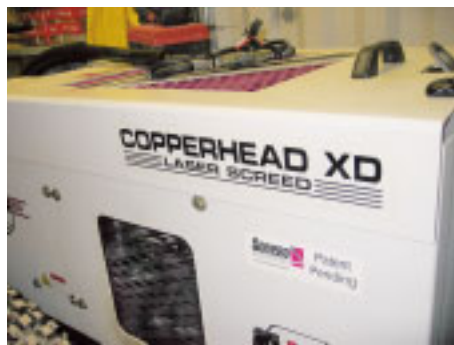
10, 11 Esimerkkejä kevyistä laserohjatuista betonimassan levitys/tiivistyskoneista.
