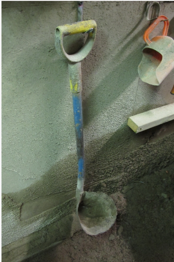
Kartiolapiolla näytteenotto suoraan sekoittajasta.
