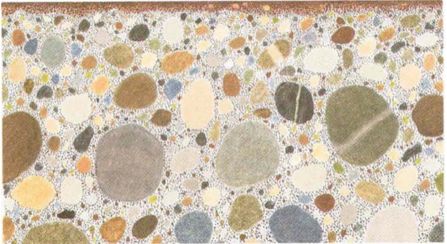
Kuva 1. Havainnekuva alusbetonista ja kuivasirotekerroksesta. (Kuva: Maritta Koivisto.)
