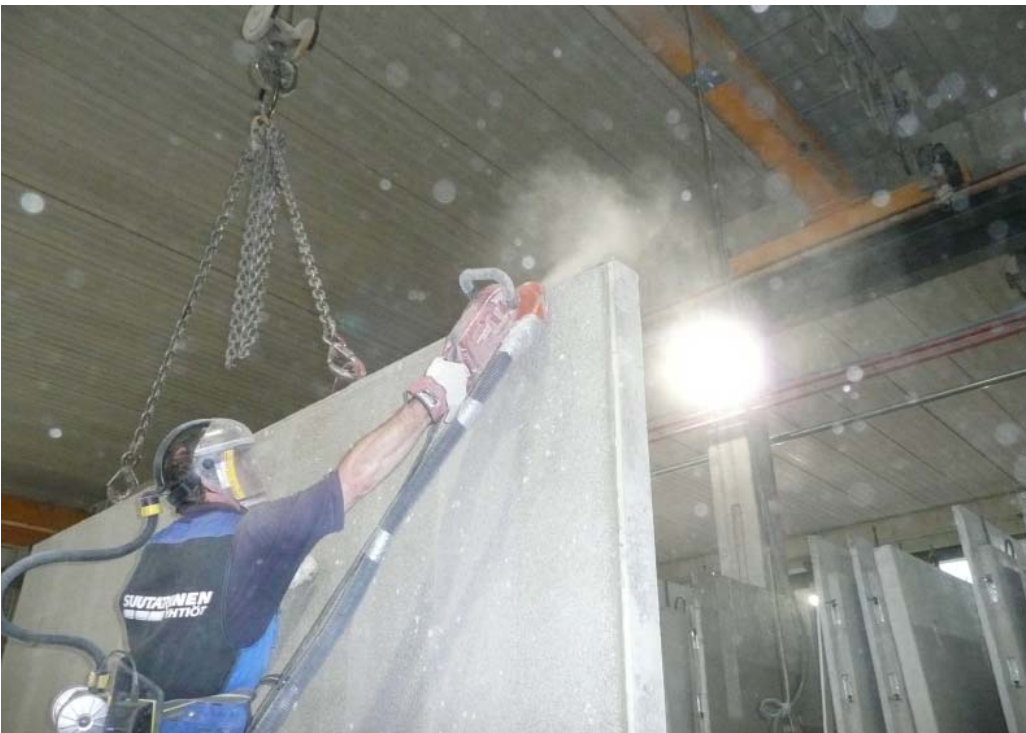
Kuva 11. Seinäelementin viimeistely käsihiomakoneella.
