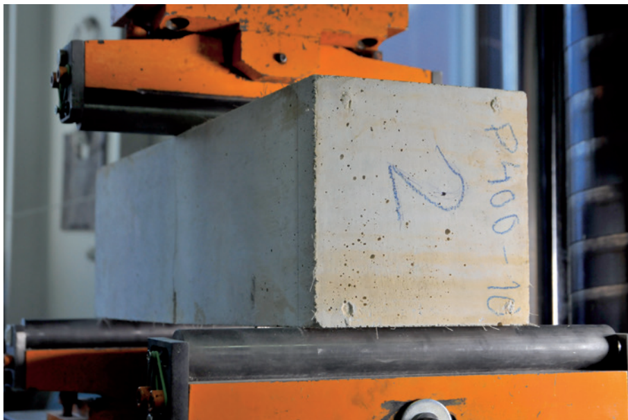
5 Kuitubetonipalkit koestettiin kolmen pisteen taivutusvetokokeella.
