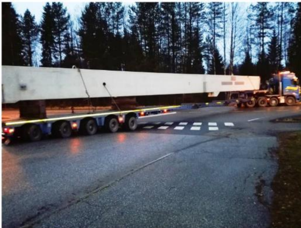
Äänekoskelle lähti alkuviikosta Iisalimesta 32 metrisiä pilareita, joilla on painoa 67 tonnia. (Kuva: Aki Nousiainen)
