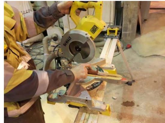
Sirkkelin teräuran puhdistus
