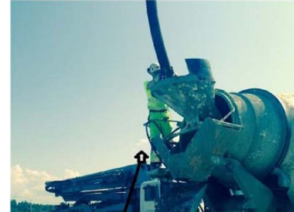
Kuljettaja tippui hoitotasolta maahan oikealle kyljelleen, taso on noin 2,5 metrin korkeudella.
