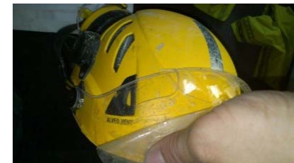
Kuljettajan kypärästä suojavisiiri on haljennut sekä muutamia naarmuja.
