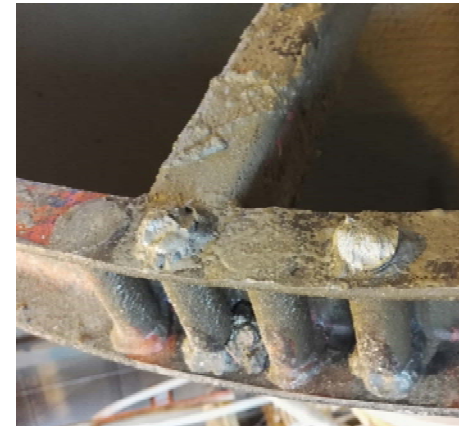
Valukuupan katkennut nostokorvake.
