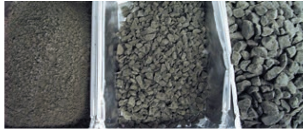
Kuva 19. Murskattu valmisbetonitehtaan liete seulonnan jälkeen. Kuvassa vasemmalla on 4 mm seulan läpäissyt, keskellä 4 mm:n seulalle jäänyt ja oikealla 8 mm:n seulalle jäänyt jae.
