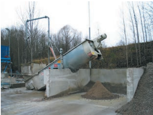
Kuva 29. Ruuvityyppinen pesuri, laitteistona Klärfix-ruuvipesuri
