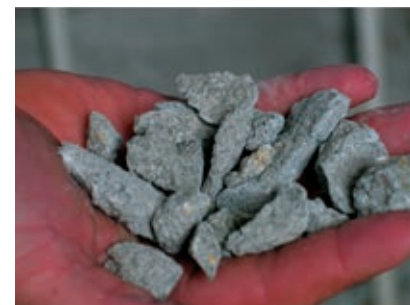
Laitoksessa murskattua betonia.
