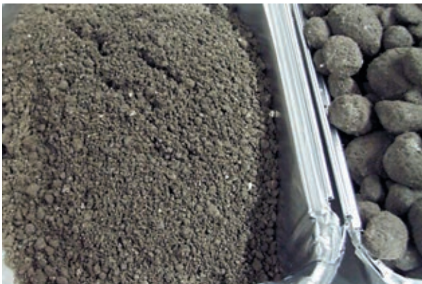
Kuva 18. Edellä (kuvassa 17) esitellystä lietteestä A valmistettuja rakeita. Liete on ensin kevyesti murskattu, pyöritetty betonimyllyssä ja kuorrutettu tuhalla. Kuvassa on vasemmalla 4 mm seulan läpäisseitä ja oikealla 8 mm:n seulalle jääneitä lieterakeita.
