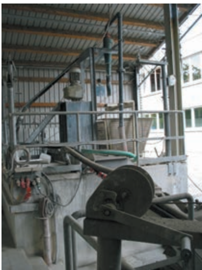
Lietesykloni ylhäällä, lietekontti sekoittimen oikealla puolella
