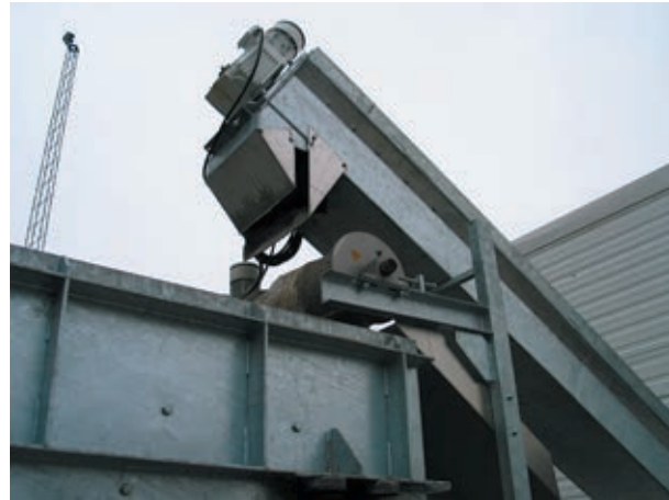
Kuva 34. Teräskuitujen erottelu magneettirummulla
