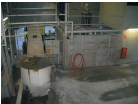
Vasemmalla pesuri, oikealla veden varastosäiliö, varustettu sekoittimella
