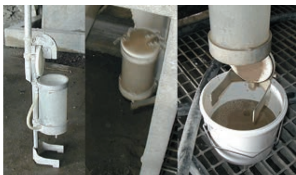
Kuva 5. Kierrätysvesinäyte tulee ottaa tarkoitukseen sopivilla välineillä siten, että saadaan edustava näyte.
