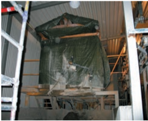
Suotopuristin väliaikaisesti lämpöeristettynä
