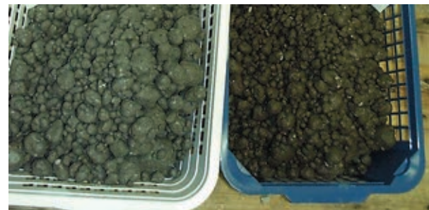
Kuva 16. Betonielementtitehtaan hiontaliettees-tä tehtyjä, tuhkalla kuorrutettuja rakeita. Kuva on otettu tuoreista lieterakeista. Vasemmalla on kivihiilituhkalla ja oikealla puutuhkalla kuorrutettuja lieterakeita.
