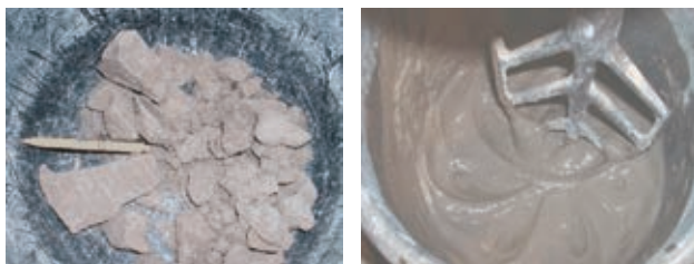
Kuva 21. Kokkareista lietettä (liete 1, vesipitoisuus 42 p.-%), josta vettä on puristettu kierrätyslaitteissa pois ja häirittyinä juokseviksi muuttuvaa suuren kosteuspitoisuuden hienoa lietettä (liete 2, vesipitoisuus 60 p.-%).
