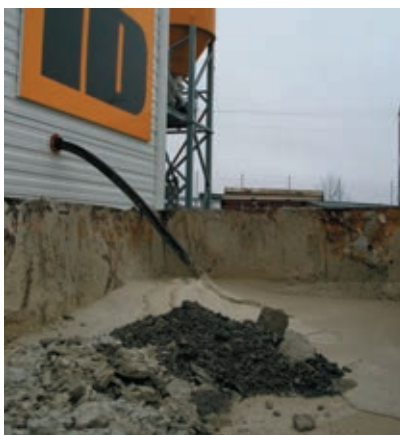
Ylijäämäliete pumpataan siirtolavalle
