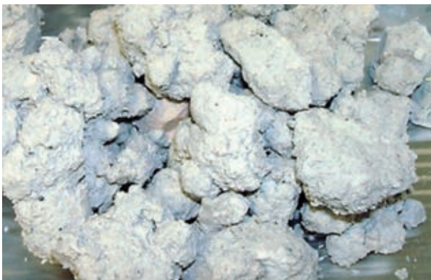
Kuva 14. Betonimyllyllä rakeistettu betoniliete. Ongelmana oli rakeiden tarttuminen toisiinsa ja taikinoituminen. Suurimpien rakeiden kokoluokka noin 40 mm.
