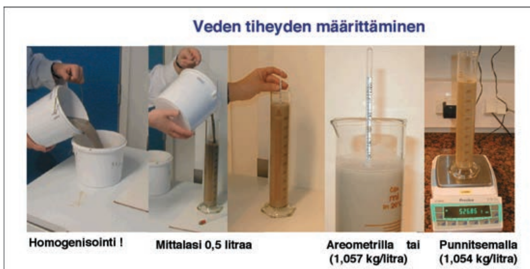
Kuva 6. Kierrätysveden tiheyden määrittäminen areometrilla tai punnitsemalla. Ennen tiheyden määrittämistä on oleellista homogenisoida näyte kaatamalla se ensin useaan kertaan astiasta toiseen ja vasta tämän jälkeen mitta-astiin.
