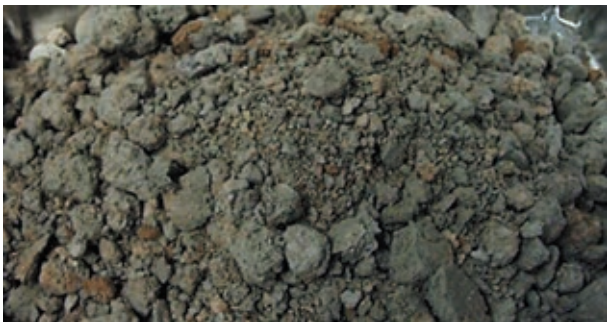
Kuva 13. Betonielementtitehtaan hiontaliete, joka on murskattu kuivauksen jälkeen (ei seulottu). Rakeiden kokoluokka on 0-20 mm.
