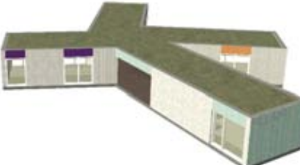
Julkisivut: harmaata lautaa sekä oranssia, violettiä, tummansinistä ja vedenväristä vanerilevyä. Viherkatto.
