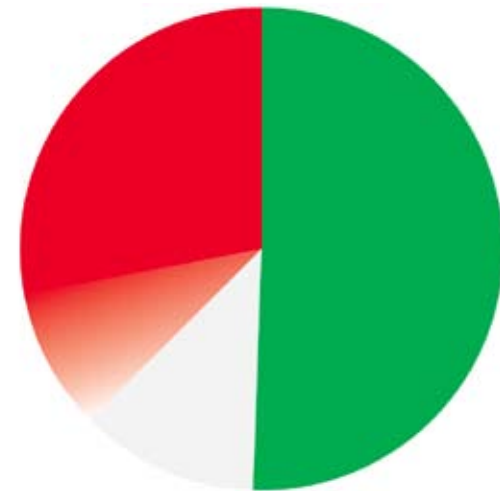
Mistä sementin CO 2 -päästöt syntyvät? Vibreä osa, reilu 50 % syntyy kalkkikiven kalsinoinnista, punainen fossiilista polttoaineista ja valkoinen CO 2 -neutraaleista polttoaineista.
