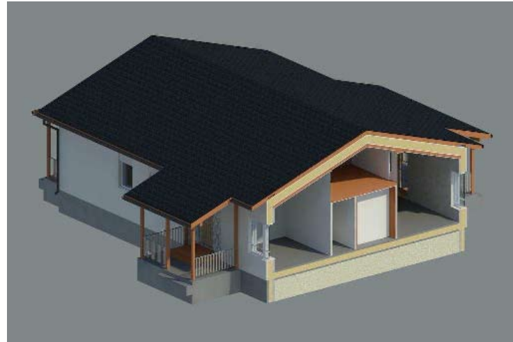
Tiivis betonielementeistä tehty passiivitalo (VTT:n mitaama ilmanvuotoluku n_{50} = 0,09 ). Suutarinen- Yhtiöt.
