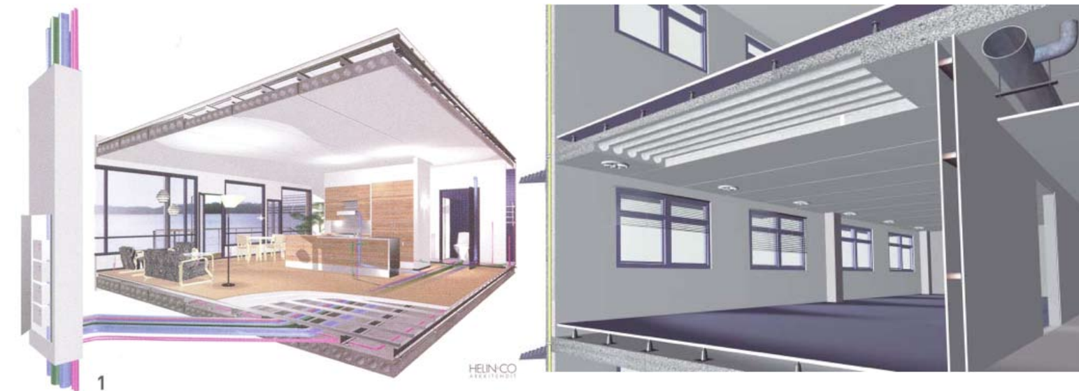
Näkyviin jäävä laatta, jossa on koneellinen lattian alapuolinen ilmanvaihto
