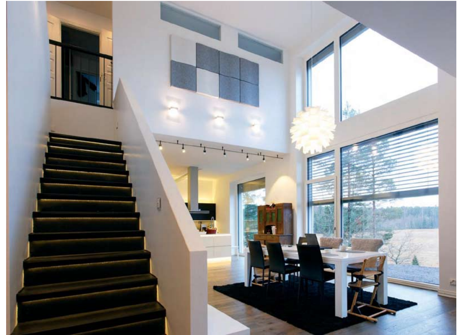
Kivitalon massiiviset osat tasaavat sisälämpötiloja varaamalla talvella auringon lämpöä ja kesällä yön viileyttä. Passiivitalo Salomaa, Kaarina / Lammi-kivitalot. Kuva: A1 Media.
