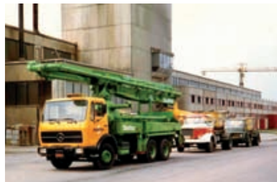
Semera hankki vuonna 1981 uuden Stetter-merkkisen betonipumppuauton, jonka takana on kaksi allassäiliöautoa. Autot ovat yhtiön Itäharjun tehtaan edessä.
