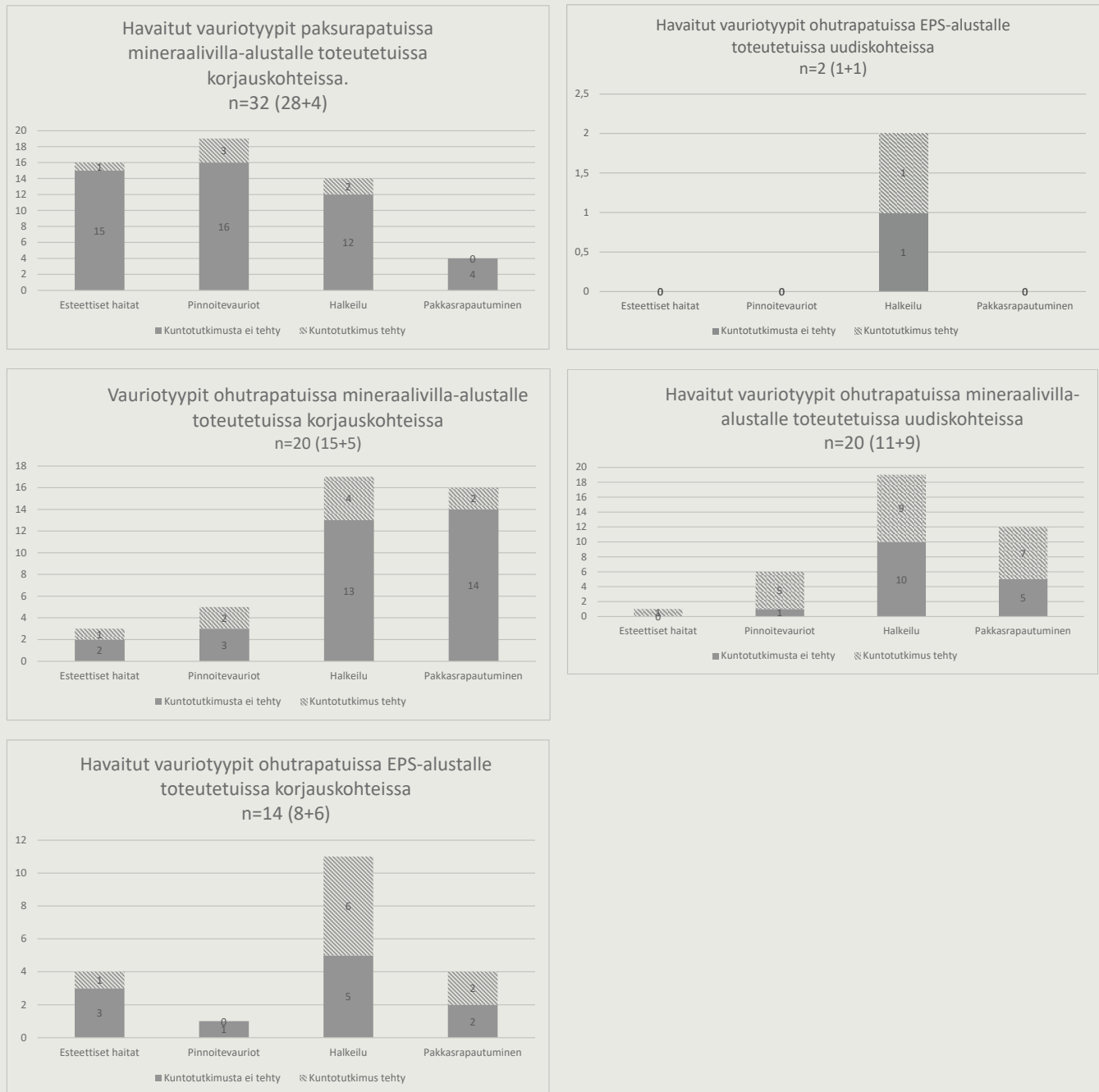
Kaavio 1 Rakennetyyppikohtaiset vauriotyypit tutkimuskohteissa.
