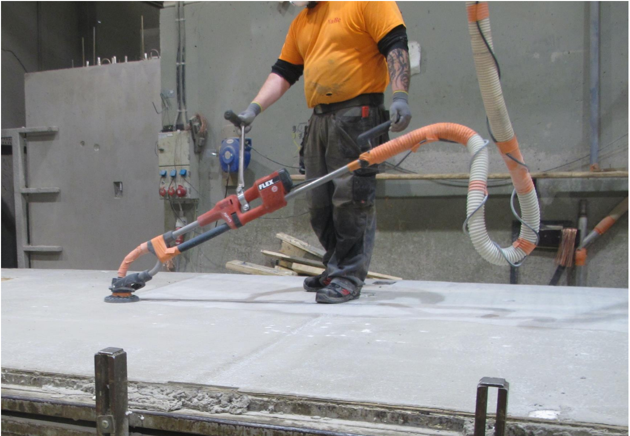
Kuva: VaBe Oy. Viimeistelyssä käytetyn hiomakoneen kohdeilmanvaihto mitoitettu ja imusuulake suunniteltu pölynmuodostuksen minimoimiseksi. Myös käyttöergonomia on suunniteltu.
