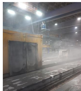
Veden ja pölyn ilmaseos ontelolaattatehtaalla sahauksen aikana
