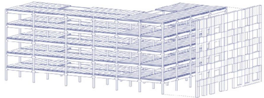
Kuva 29 Kierrätetyn kerrostalon runkorakenne (Järvelä 2021).
