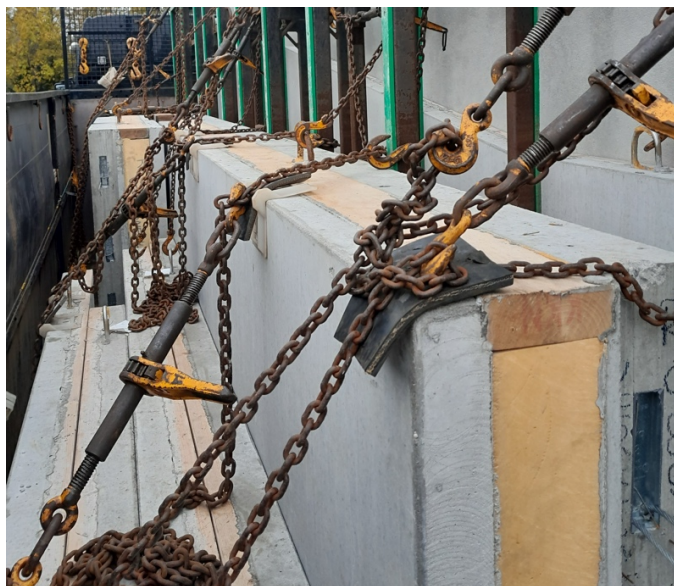
Kuva 3. Sekä sidontaketjut että kuorma suojataan vaurioitumiselta.
