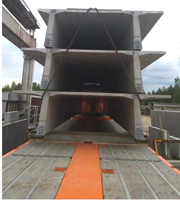
Esimerkki ristikkäisvinosidonnan soveltamisesta TT-laattakuormalle.
