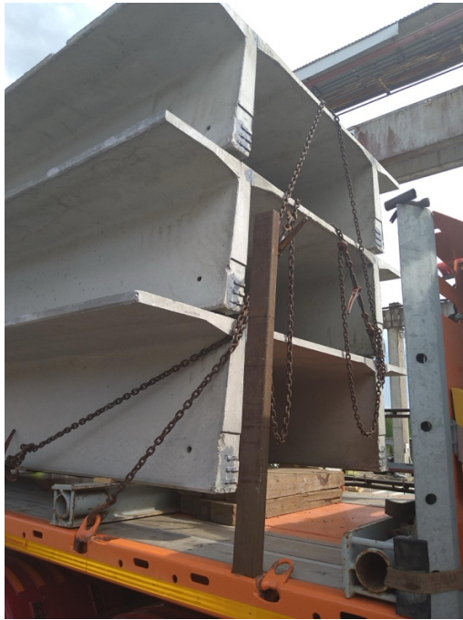
Esimerkki ristikkäisvinosidonnan soveltamisesta TT-laattakuormalle.
