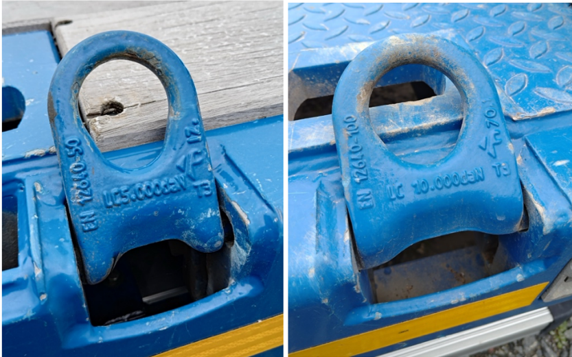
Kuva 7. Sidontapisteet merkittynä kuljetusalustassa standardin SFS-EN 12640 mukaan (LC-arvot).
