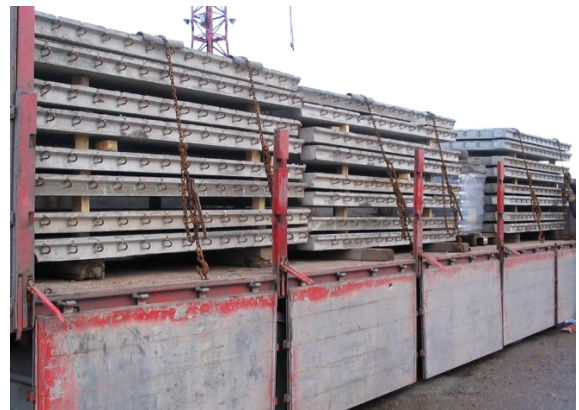
Kuva 2. Kitkasidonta eli ylisidonta. HUOM! oikealla olevassa kuvassa ketjut vedetään välipuiden kohdalta.
