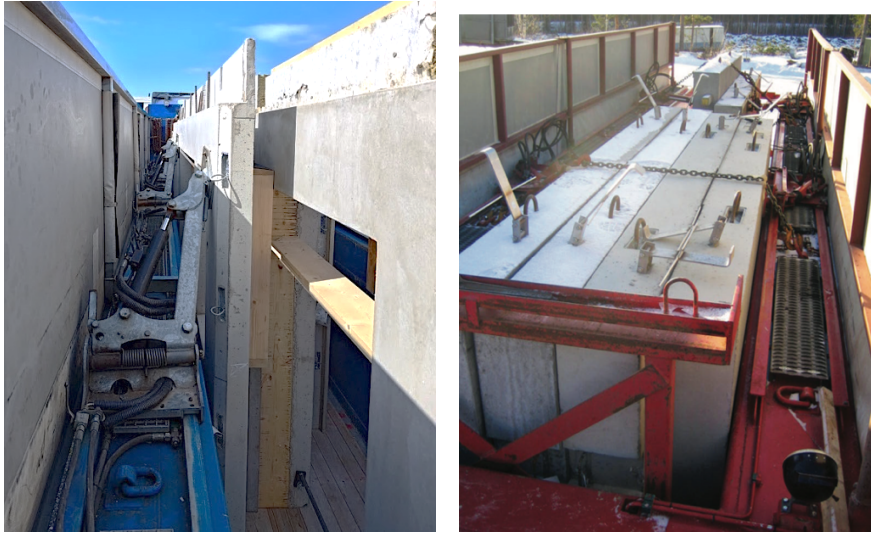
Vasemmalla hydrauliset tukitassut ja oikealla sidontaketjut ja tukitassut käytössä kuorman varmistamiseen.
