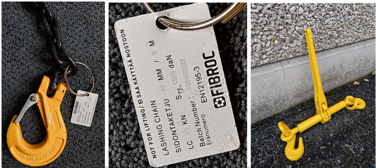
Kuva 9. Sidontaketjut ja kiristimet merkitty suoritusarvoilla ja ne ovat yhteensopivat keskenään (EN 12195-3).
