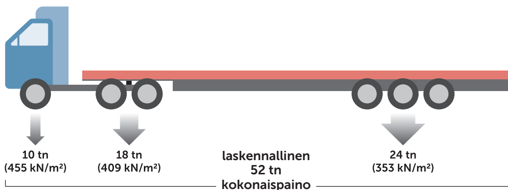
Kuva 9. Paalurekan esimerkinomaiset akselipainot ja pintapaineet 52 t kokonaispainolle.
